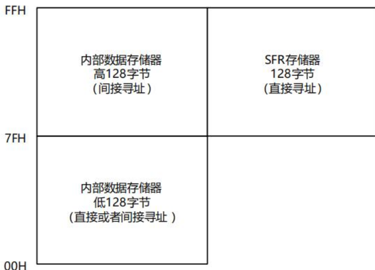
内部数据存储器结构图
